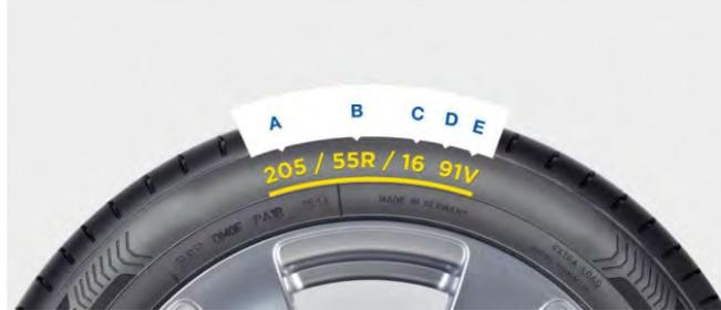
Fig. 1.3.2. Tyre sidewall coding
